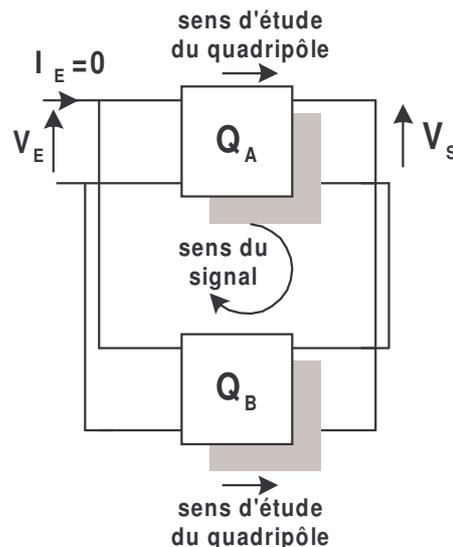
La condition d'oscillation sur le quadripôle équivalent se détermine alors en remarquant que les courants d'entrée et de sortie de celui-ci doit être nuls : en effet le montage est autonome (au sens des petits signaux) et ne reçoit donc pas de signal en entrée, ni n'en fournit en sortie. Une éventuelle charge en sortie doit le cas échéant être incluse dans le quadripôle. On arrive alors à :
